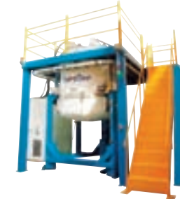
シリコン多結晶製造装置
