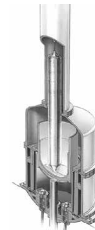
図2 シリコン単結晶引上装置
