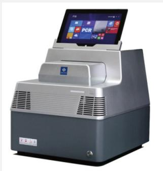
**DNA増幅用途(バイオ)で、顕微鏡では見ることのできない病原体の有無を検査<PCR法>**
